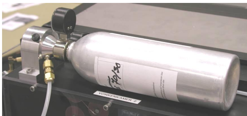
Spuitbus met GLOOR reduceerventiel op vonkenkamer
